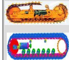
学习情境取自小松山推、山推股份等企业，从支重轮、涨紧装置、引导轮、托轮、履带的数字化设计到履带行走装置的数字化总装，涵盖整个履带行走装置的企业设计、生产过程。
